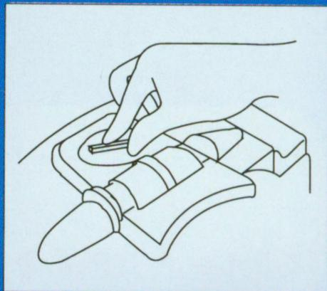
調整画面を見ながら、本体上部にある「目の幅調整ダイヤル」をまわし、画面の4すみにあるマークが見える状態に合わせてください。
