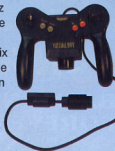
La manette de la VB est composée de deux poignées, de deux croix de direction ainsi que de six boutons.
