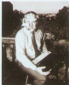
◆このプライベート・アイが、バーチャルボーイの原型とも言えるもの。プライベート・アイは、ユーザーの数センチまえに仮想の画面を浮かび上がらせるもので、膨大な資料を必要とする航空機の整備などのために使用されていたのだ。
