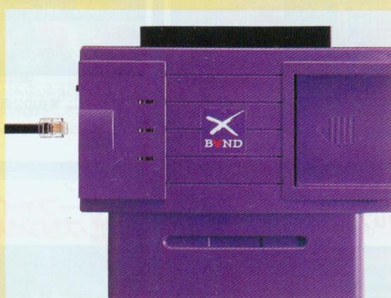
電話回線を使用して、遠隔地の人とゲームが対戦できるスープーパーファミコン専用のモードム。利用方法はスープーパーファミコン本体にこのモードムを差し込み電話ケーブルをつなぐだけ。日本中のフレーリーと対戦が楽しめるぞ。
