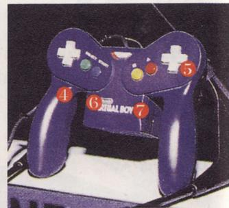
• **Der Virtual Boy kann batterie- oder netzbetrieben werden. Auf dem „griffigen“ Joypad befinden sich zwei Steuerkreuze für vertikale und horizontale Bewegung (4) und Bewegung in die Raumtiefe (5), Start- und Select-Knöpfe (6) sowie zwei Aktionstasten (7).**
